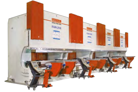
Abkant Pres Tandem 14800 mm x 2400 ton Press Brake Tandem 14800 mm x 2400 tons
