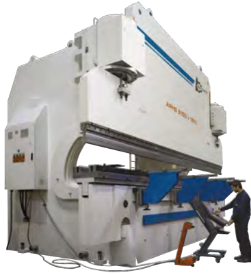
Abkant Pres 8100 mm x 1600 ton Press Brake 8100 mm x 1600 tons
