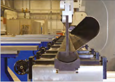
Abkant Pres 8100 mm x 1000 ton Press Brake 8100 mm x 1000 tons
