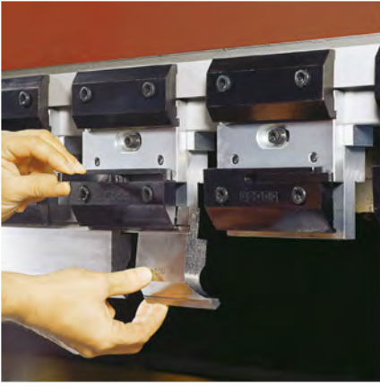
Kolay açılır kalıp tutma sistemi Quick release clamps
