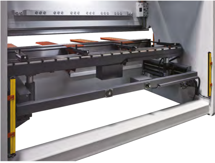
Ağır tip iki eksen arka dayama (X-R) Heavy duty two axis backgauge (X-R)
