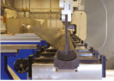
Abkant Pres Tandem 14200 mm x 1400 ton Press Brake Tandem 14200 mm x 1400 tons
